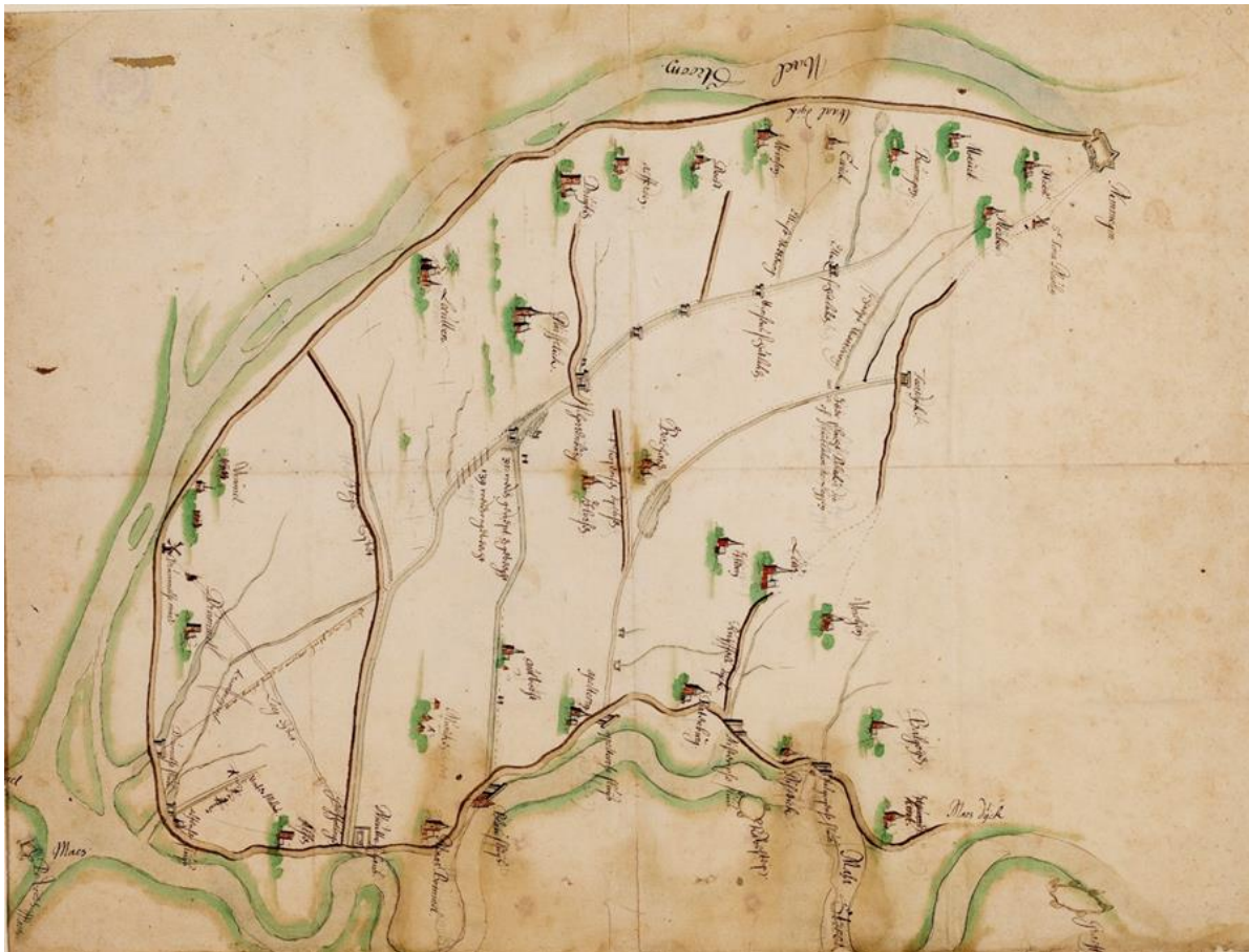
Figuur 3.1. Kaart uit ca 1500 van het westelijk deel van het land van Maas en Waal met de dan al doorgaande dijkkring en de (eerder aangelegde) zijdwendes bij de dorpen. De Waal (bovenaan) was nog dynamisch met eilanden.
