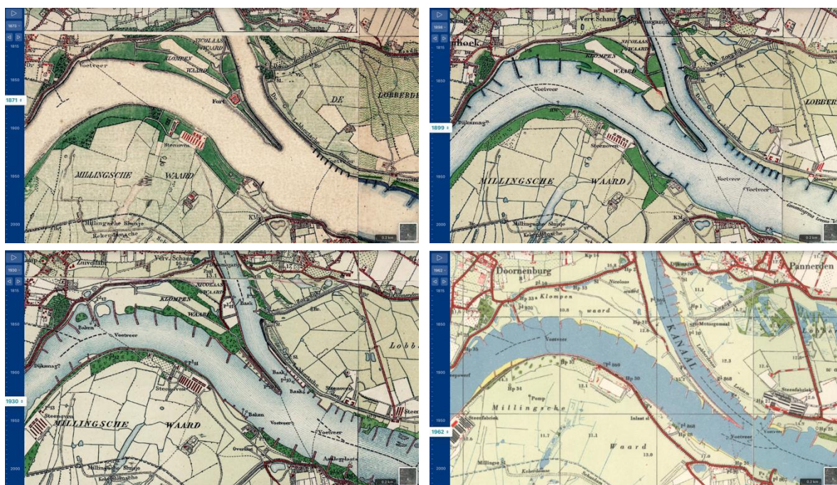
Figuur 3.8. De kribben werden in enkele fasen aangelegd en later ook nog vaak aangepast. Het jaartal staat in de linker kolom naar de kaart (bron: kadaster).
