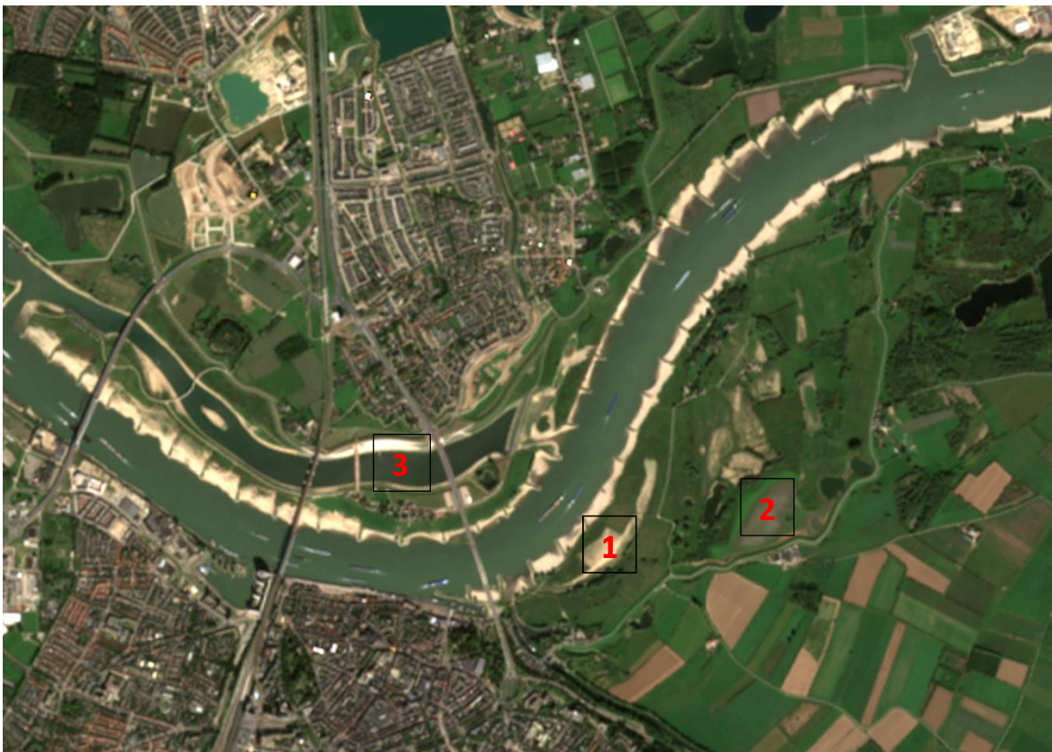
Figuur 4.28. Satellietbeeld uit september 2018 tijdens een periode van zeer lage waterstanden. In de Buiten-Ooij bij Nijmegen is de nevengeul drooggevallen (nr. 1) en ook de Oude Waal viel dat jaar voor het eerst droog (nr. 2). De ten behoeve van hoogwaterbescherming extra diepe Spiegelwaal (nr 3) viel niet droog. De rivierstranden zijn ook opvallend breed.
