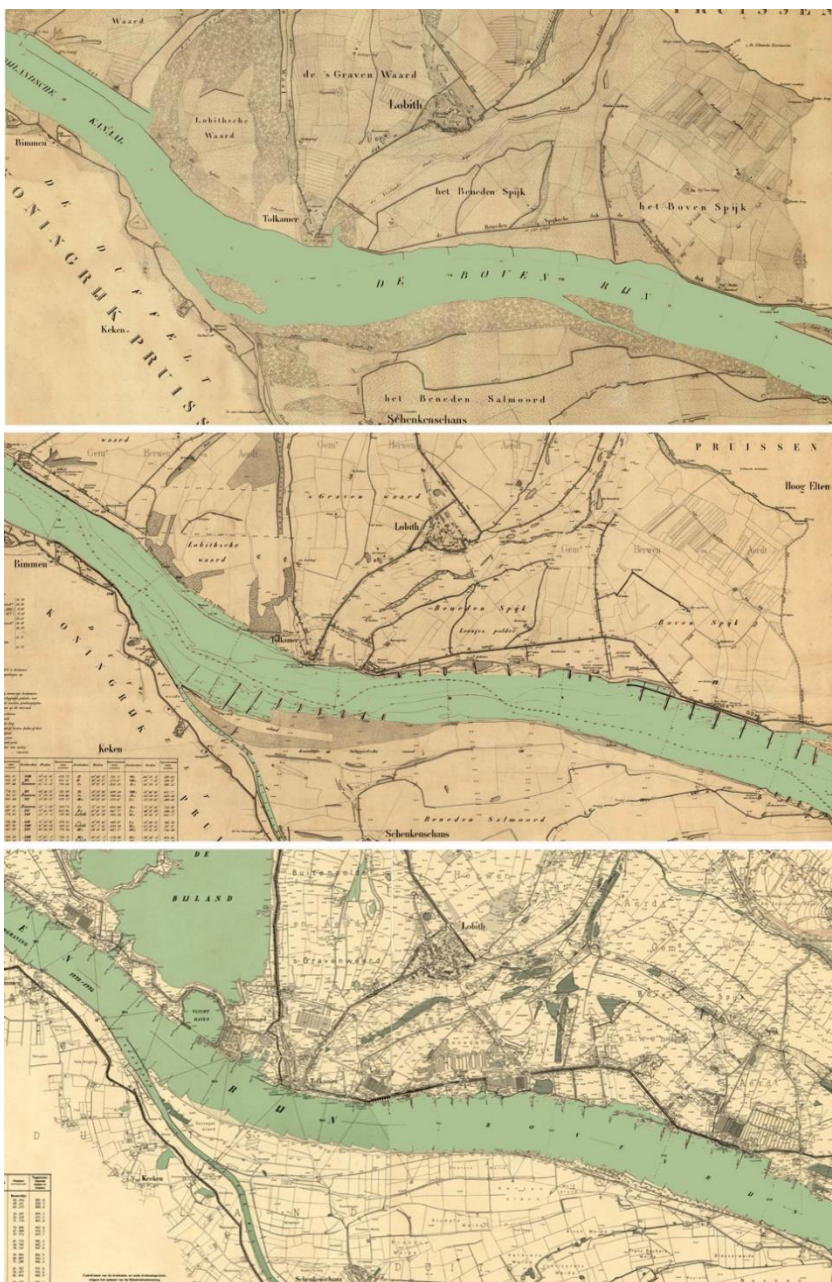
Figuur 3.7. Fasen uit de riviernormalisatie van Boven-Rijn tussen Spijk en Lobith aan de hand van 3 rivierkaarten: boven in 1850, midden in 1900 en onder in 1960. (Bron: RWS) 11
