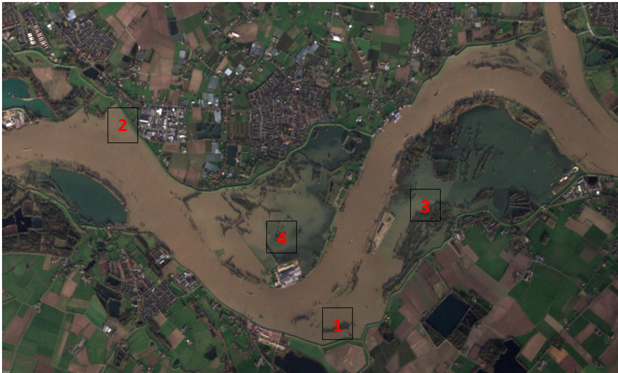
Figuur 4.14. Satellietfoto tijdens het hoogwater van januari 2018 waarop duidelijk het slibtransport in de rivier zichtbaar is. In de uiterwaarden die mee stromen zoals de Erlecomse Waard en de Konijnenwaard (nrs. 1 en 2) wordt het slib doorgevoerd, in uiterwaarden die zich vanaf benedenstrooms langzaam vullen zoals de Millingerwaard en de Gendtse Waard (nrs. 3 en 4) dringt het slib maar langzaam de uiterwaard in en bezinkt het grootste deel al onderweg.
