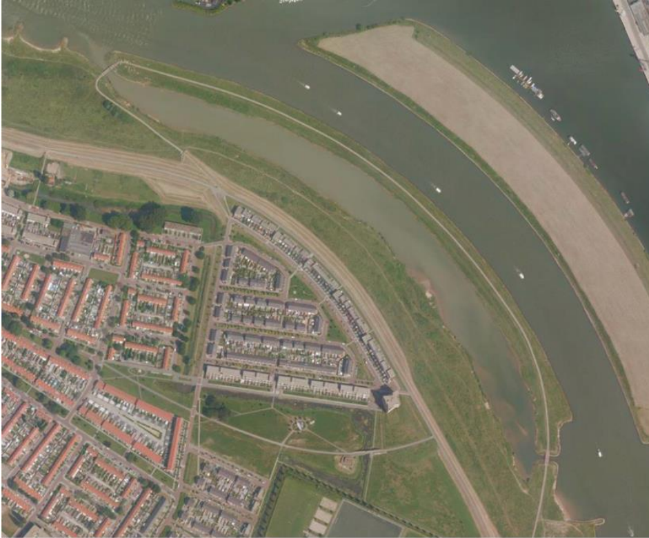
Figuur 4.42. Transport van slib vanuit de stromende nevengeul. Dat in geulen niet alleen sediment neerslaat, maar ook erodeert blijkt uit deze momentopname. Tijdens oplopende afvoeren en meer water dat door de geul gaat stromen kan slib dat eerder tijdens afnemende afvoeren is bezonken weer worden opgepakt.
