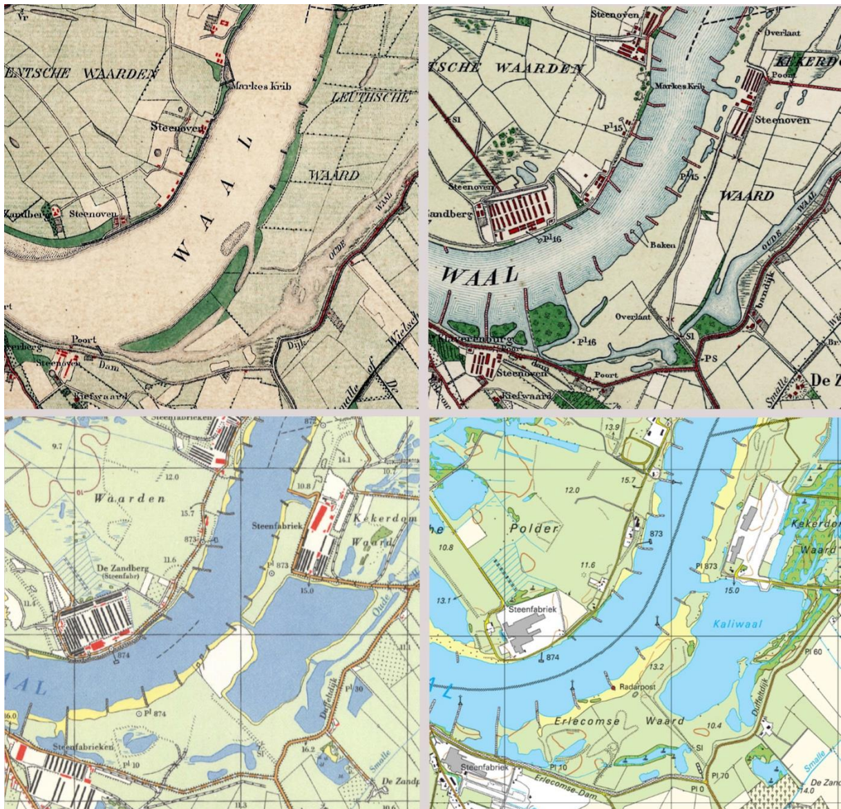
Figuur 3.9. De ontwikkeling van hogere zandige oeverwallen naast het zomerbed kwam pas op gang nadat de rivierbedding was vastgelegd met kribben. Historische kaarten laten deze ontwikkeling goed zien. Linksboven is de situatie afgebeeld rond 1880 voorafgaand aan de normalisatie met kribben. De oevers zijn laag en begroeid met bos; lokaal is zand zichtbaar (o.a. links voor de bocht van de Gendtse waard). Rond 1930 is het bos bijna overal verdwenen en heeft plaats gemaakt voor grasland. Zand is nergens zichtbaar, of niet afgebeeld; een smalle strook zou namelijk tussen de kribben wel kunnen liggen. Vanaf 1965 (linksonder) is de zandige oever wel zichtbaar en in 2020 (rechtsonder) is deze nog duidelijker.
