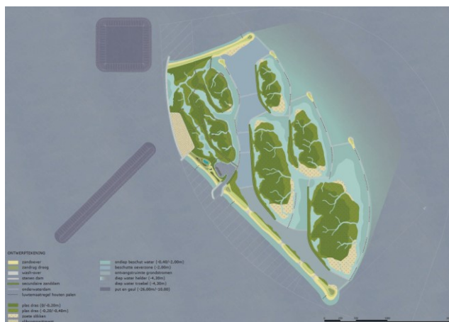
Figuur 9 Ontwerp Marker Wadden fase 1 opgesteld voor aanleg.
