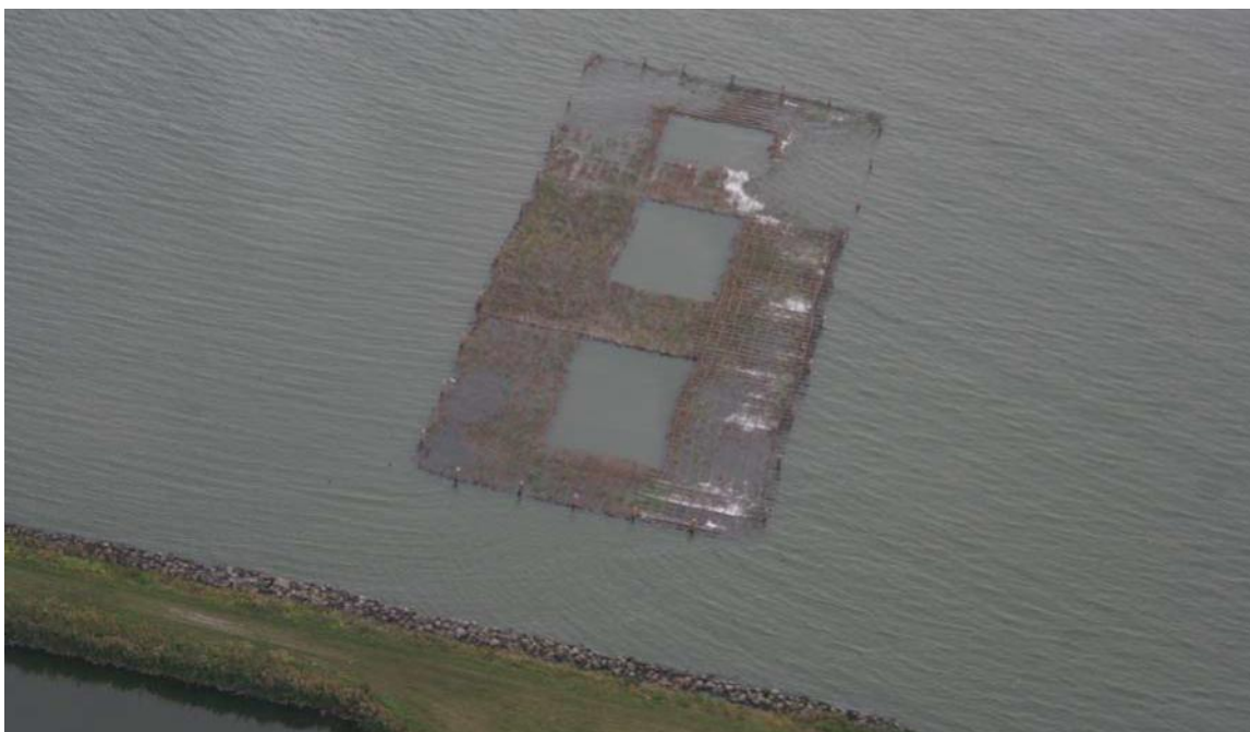
Figuur 5.5. Rijshoutmat met riet tijdens het experiment (Van Geest e.a., 2010)
